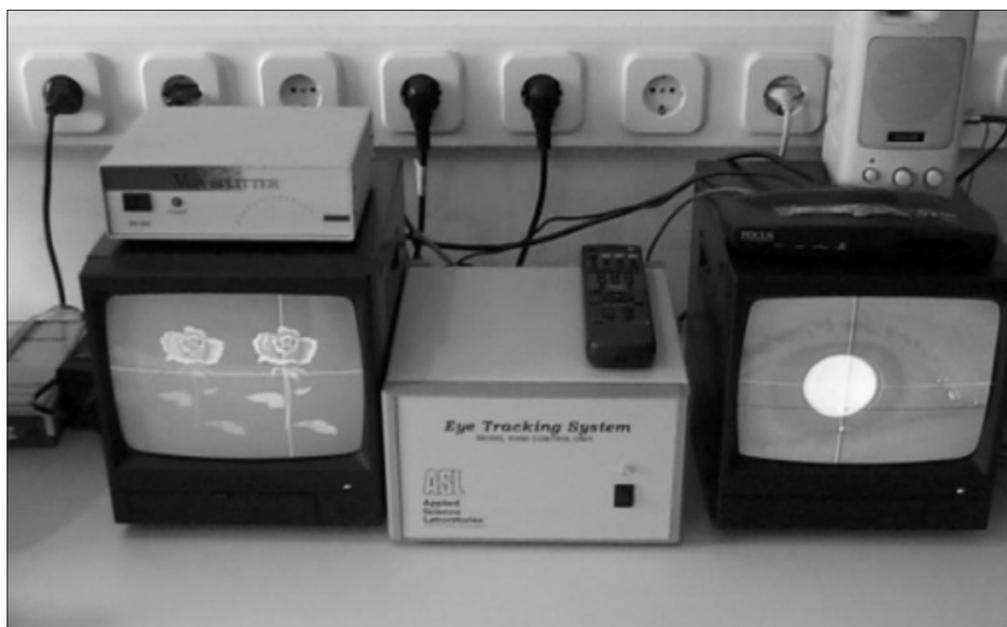
FIGURA 2: Unidad de control del modelo ASL 504. En el monitor izquierdo se visualiza la escena presentada y la línea de la mirada; en el derecho se aprecia el ojo captado por la cámara ocular. El sujeto está ubicado en una dependencia anexa explorando la imagen de las flores que le están siendo presentadas sobre un monitor de ordenador (Laboratorio de Percepción y Movimientos Oculares, Departamento de Psicología Básica II, UNED).
