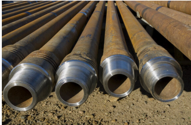
Figura 26: Drill pipes soldados mediante soldadura por inercia. [31]
