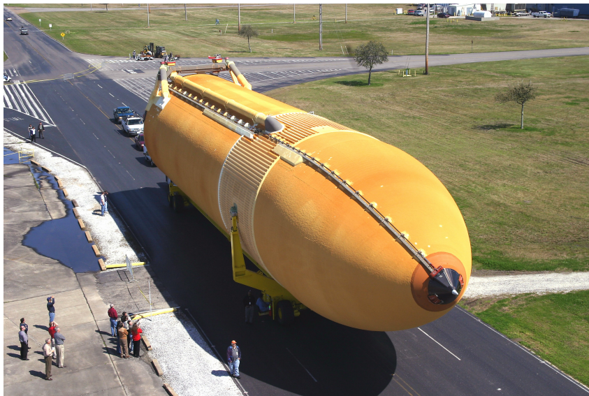
Figura 41: Tanque exterior Transbordador espacial soldado por FSW. [31]
