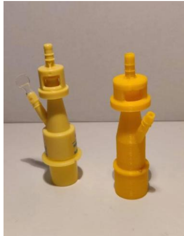
Figura 12: “rapid manufacturing” de una válvula de máquina de reanimación mediante FDM [18]
