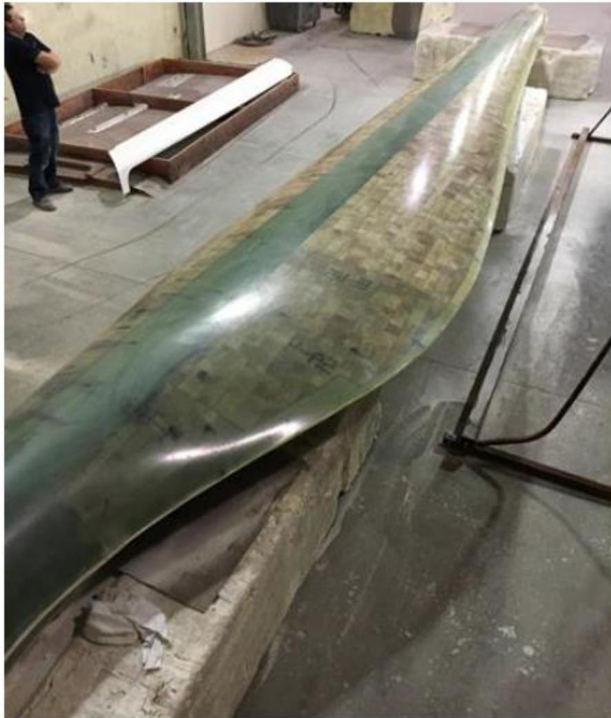
**Figura 24. Pala eólica finalizada (Post *et al.*, 2017b).**
