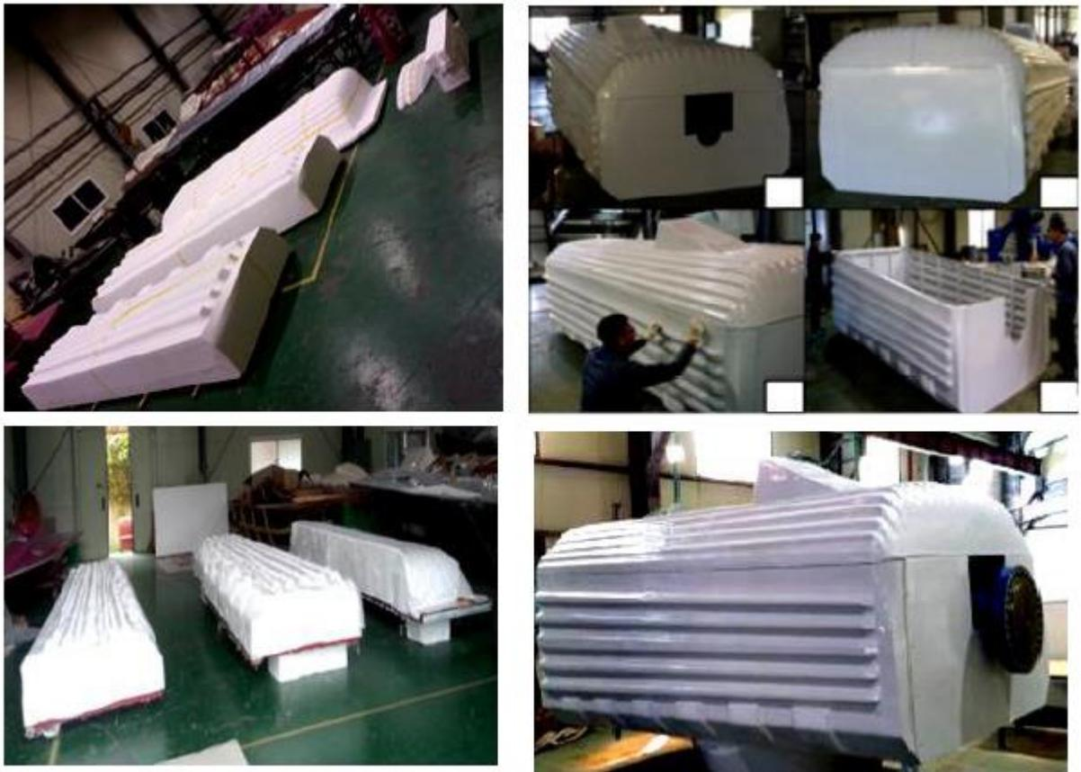
**Figura 26** Etapas de la fabricación de una cubierta de góndola cableada de materiales compuestos (Jung, 2020),
