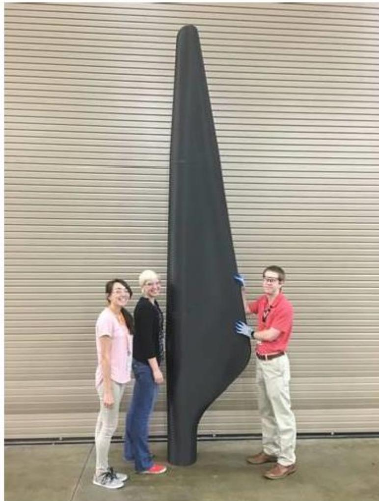
**Figura 44. Pala eólica impresa en 3D (Post *et al.*, 2017b).**
