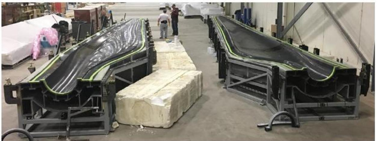
**Figura 23. Moldes finales (Alta presión y baja presión) (Post *et al.*, 2017b).**
