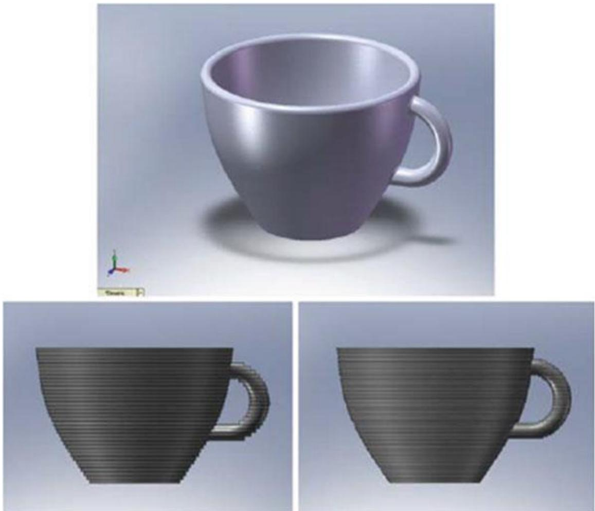
**Figura 4. Imagen CAD de una taza con más imágenes que muestran los efectos de la construcción con diferentes espesores de capa (Gibson *et al.*, 2015).**
