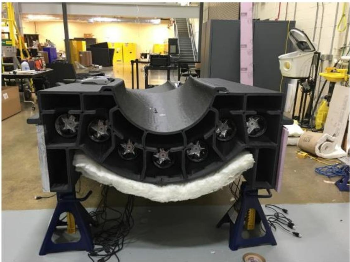
Figura 21. Unidades de calentador ORNL/TPI integradas en la sección del molde de la pala (Post *et al.*, 2017b).
