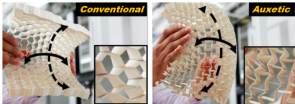
Figura 3.6: Comportamiento de curvatura sinclástica (en forma de cúpula) de materiales con una relación de Poisson negativa [42].
