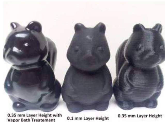
Figura 2.29: Diferencia de acabados según el espesor de capa y el tratamiento superficial de la pieza. [38].
