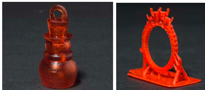
Figura 2.13: Ejemplos de piezas obtenida mediante fotopolimerización [38].
