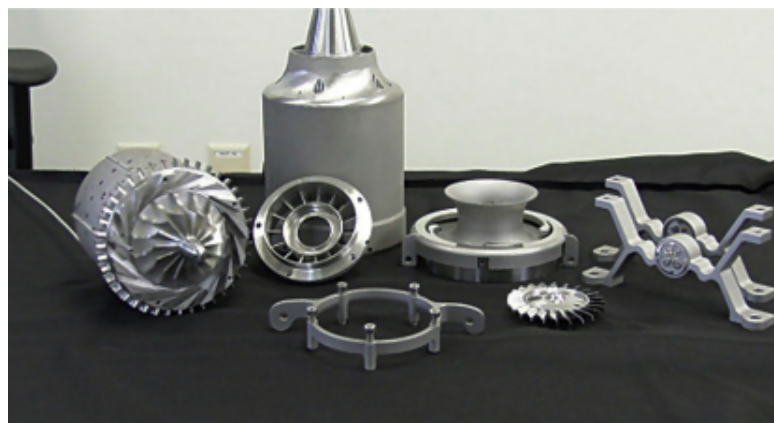
Figura 2.33: Ejemplos de piezas metálicas fabricadas por fabricación aditiva. [28].
