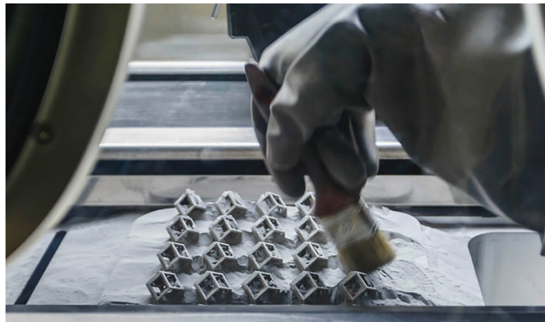
Figura 2.9: Postprocesado de una pieza fabricada mediante tecnologías aditivas [60].
