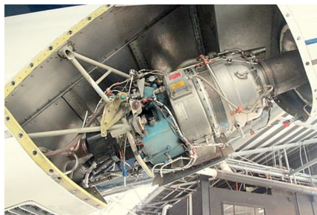
Figura 4.7: APU Honeywell GTCP36 montada debajo de la cola de un avión comercial [82].
