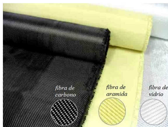
Figura 4.4: Tipos de fibras utilizadas como refuerzo en materiales compuestos [24].
