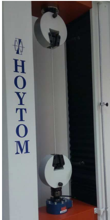
Figura 179. Probeta de Filaflex sometida a ensayo de tracción
