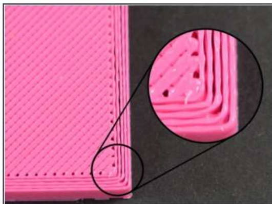
Figura 56. Extrusión insuficiente (Simplify3D, 2017)
