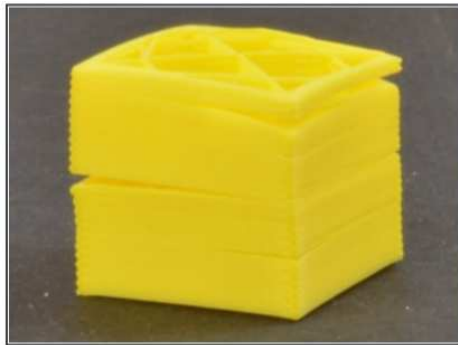
Figura 59. Mala unión de las capas (Simplify3D, 2017)
