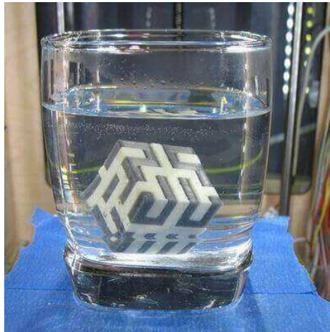
Figura 51. Material de soporte PVA soluble en agua (All3DP, 2017)
