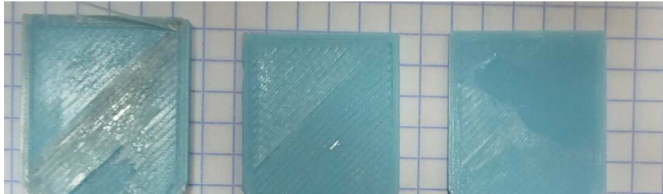
Figura 127. Distintos resultados de la base en función del juego inicial boquilla-plataforma
