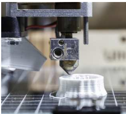
Figura 22. Deposición de material en proceso FDM/FFF (Rep-Rap Project, 2017)
