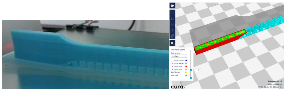
Figura 133. Uso de soportes para la orientación de fabricación 2
