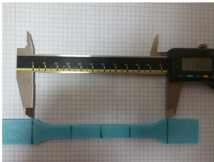
Figura 113. Medida de las probetas y trazado de las marcas de referencia
