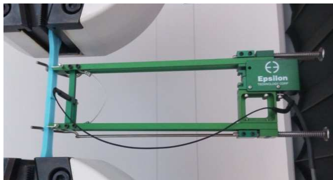
Figura 115. Colocación del extensómetro
