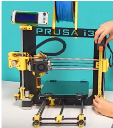
Figura 99. Nivelación del carro del cabezal extrusor (Trainnova, 2016)
