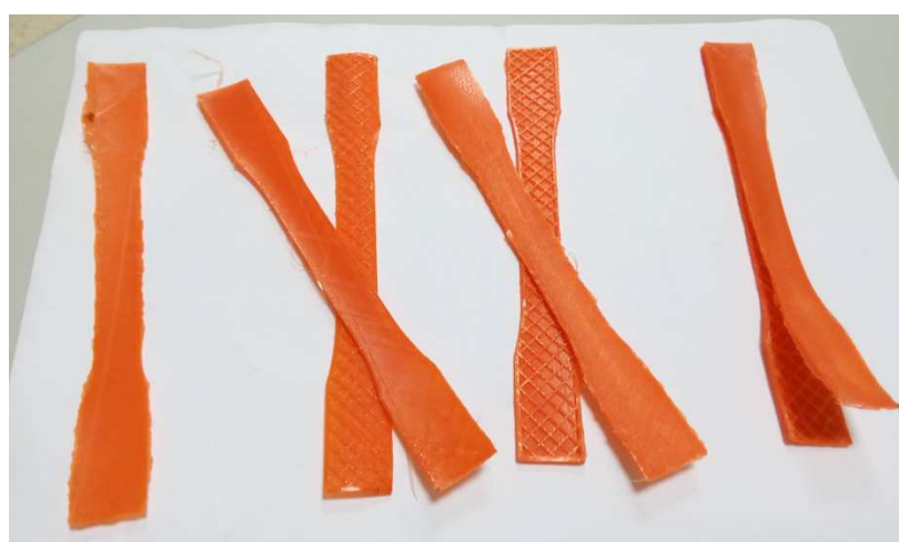
Figura 135. Intentos fallidos de impresión con nylon
