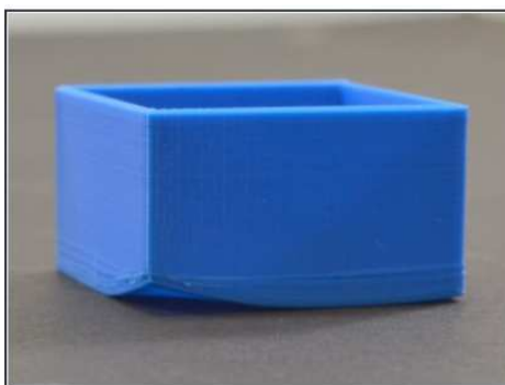
Figura 57. Deformación en la base de la pieza ( warping ) (Simplify3D, 2017)
