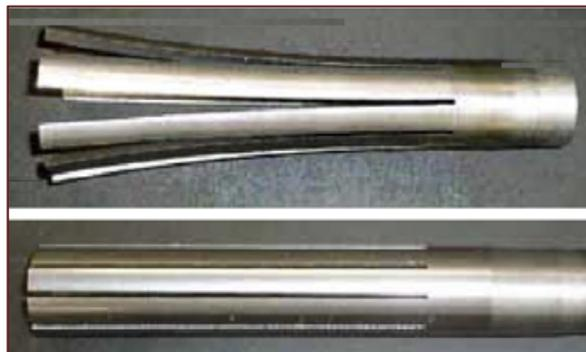
Figura 6.17. Comparación entre dos tubos estirados y mecanizados paralelos a sus ejes longitudinales: superior, con tensiones residuales; inferior, sin tensiones residuales (adaptada de Kuboki *et al.*, 2008).
