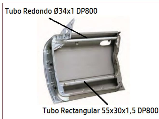
Figura 5.3. Puerta lateral de la carrocería de un automóvil con dos perfiles tubulares de sección constante, uno redondo y otro rectangular, fabricados en DP800 (adaptada de Keeler *et al.*, 2017).
