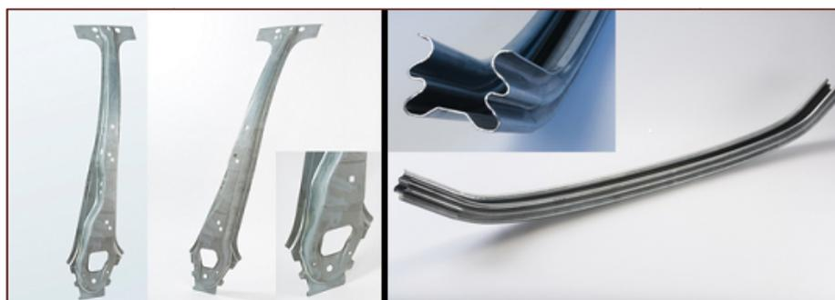
Figura 3.10. Ejemplos de componentes fabricados en aceros TRIP: izquierda, refuerzo de pie central de 1,2 mm de espesor en TRIP780; derecha, travesaño de parachoques de 1,6 mm de espesor fabricado en TRIP780 (<http://automotive.arcelormittal.com/europe/products/AHSS/TRIP/ES>).
