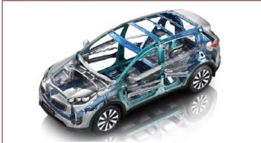
Figura 3.12. Chasis-estructura del KIA Sportage, formado en un 51% por AHSS (Keeler et al., 2017).
