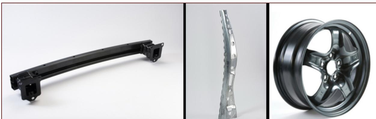
Figura 3.8. Ejemplos de componentes fabricados en aceros DP: izquierda, parachoques de 1,35 mm de espesor en DP1180; centro, refuerzo central de automóvil en DP980; derecha, llanta fabricada en DP600 (<http://automotive.arcelormittal.com/europe/products/AHSS/DP/ES>).
