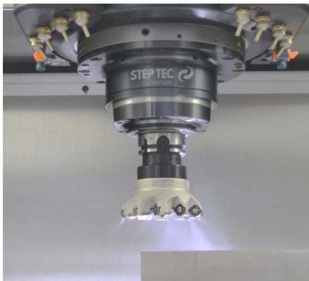
*Figura 17 Ejemplo herramienta para mecanizado MQL (www.blaser.com)*
