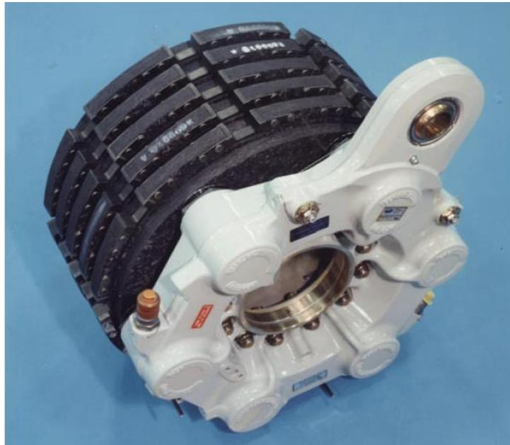
*Figura 15 Conjunto de freno de carbono de Boeing 767 [17]*
