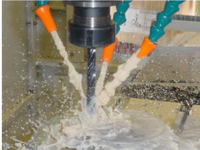
*Figura 16 Ejemplo de mecanizado por inundación [26]*
