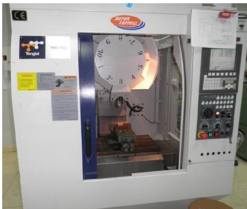
Figura 23 Centro de mecanizado Tongtai TMV510
