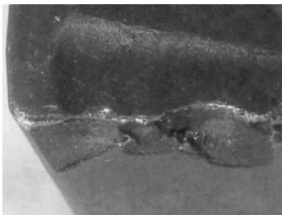
Figura 8 – Desgaste de la herramienta por fatiga debido a las vibraciones y ciclos térmicos (Byers, 2006)
